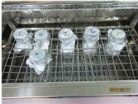
< 그림 1-23. 좌: 진탕배양기로 용출하는 모습, 우 : 용출물 좌로부터 PP, silicon, Stainless steel >
