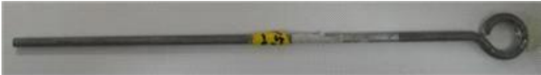
< 그림 3. 길이 100mm, 지름 4mm 금속제 시험편 >
