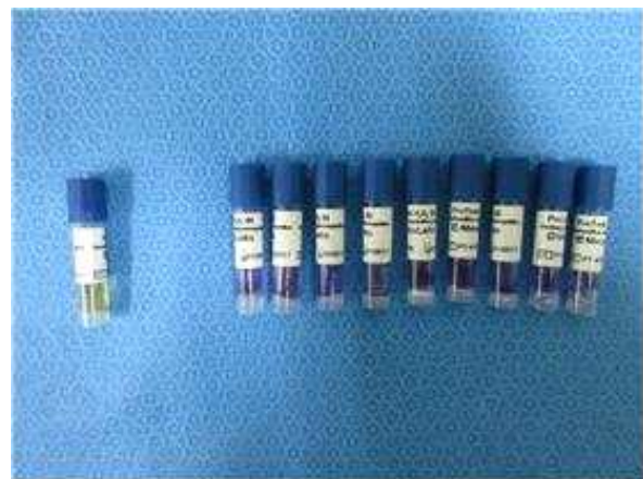
< 그림 3-12, 13. 좌: 상단트레이, 우: 하단트레이, 좌측부터 음성대조군, B.I 배치 A~I > - 모든 위치에서 멸균이 확인되었다.
