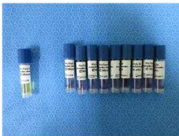
< 그림 3-14, 15. 좌: 상단트레이, 우: 하단트레이, 좌측부터 음성대조군, B.I 배치 A~I > - 모든 위치에서 멸균이 확인되었다.
