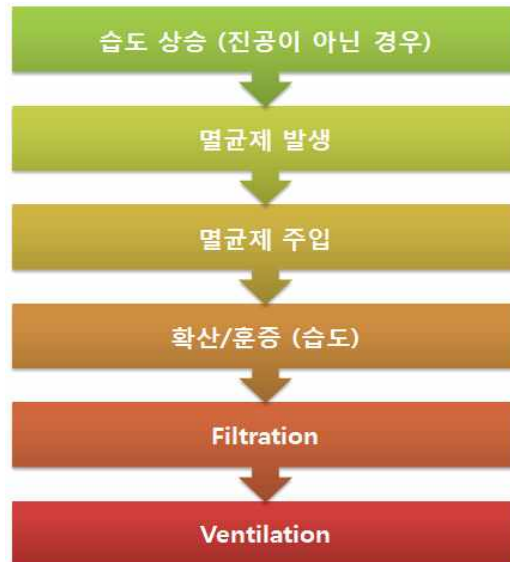
< 그림 13. 이산화염소가스 멸균기의 기본 멸균 공정 예시 >
