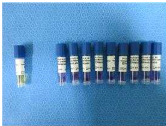
< 그림 3-12, 13. 좌: 상단트레이, 우: 하단트레이, 좌측부터 음성대조군, B.I 배치 A~I > - 모든 위치에서 멸균이 확인되었다.
