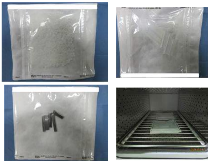
<그림 1-22. 좌측 상단부터 Tyvek 포장된 Polypropylene, silicon, stainless steel, 멸균 챔버적재>
