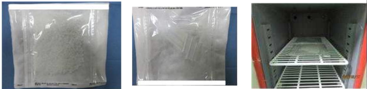
< 그림 3-20. 좌측 부터 Tyvek 포장된 Polypropylene, silicon, 챔버 적재, >
