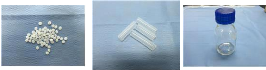
< 그림 3-19. 재질시편 좌측 부터 Polypropylene, silicon, 유리 >
