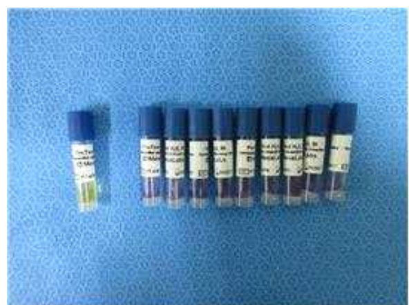
< 그림 3-14, 15. 좌: 상단트레이, 우: 하단트레이, 좌측부터 음성대조군, B.I 배치 A~I > - 모든 위치에서 멸균이 확인되었다.
