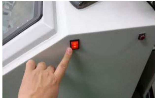
그림 10. 전원 공급(ON 상태) 예시
