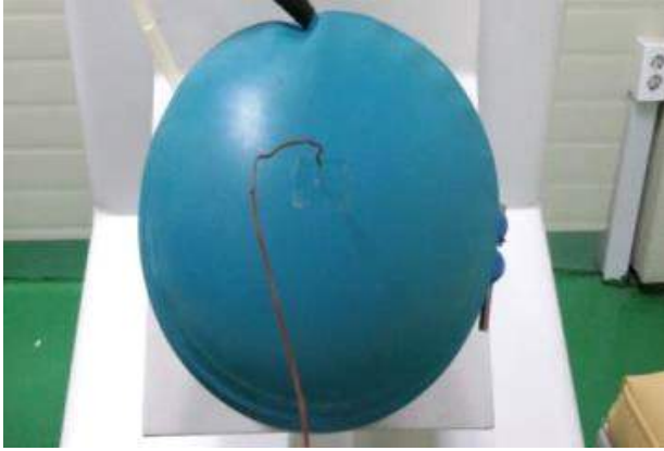
그림 7. 충격파발생부 온도 기록계 설치
