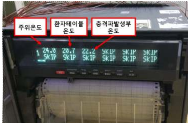
그림 8. 온도기록계 결과 값 측정 예시
